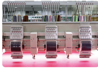
ระบบเหน็บเส้นด้ายและกอนำด้ายรุ่นใหม่ ช่วยให้การเดินด้ายราบรื่น ลดปัญหาด้ายขาด และเพิ่มประสิทธิภาพการปัก
