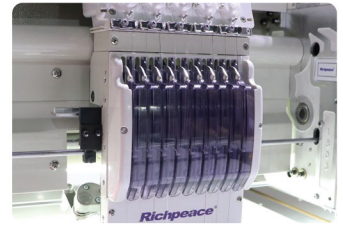
ฝาครอบใสแบบรวมระบบนำด้ายภายใน ช่วยให้การร้อยด้ายสะดวก รวดเร็ว และช่วยต่อการใช้งาน
