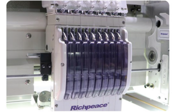
ฝาครอบใสแบบรวมระบบนำด้ายภายใน ช่วยให้การร้อยด้ายสะดวก รวดเร็ว และง่ายต่อการใช้งาน
