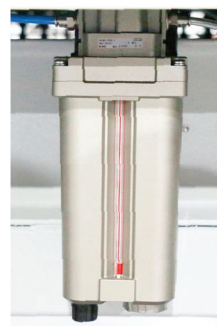
ระบบหล่อเส้นแบบละ อองอัตโนมัติ SMC
