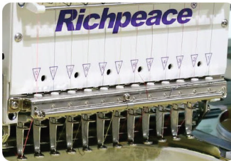
ตัวยึดด้ายด้านบนแบบใหม่: ช่วยลดอัตราการขาดของด้าย
