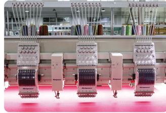
ระบบหนีเส้นด้ายและกอนำด้ายรุ่นใหม่ ช่วยให้การเดินด้ายราบรื่น ลดปัญหาด้ายขาด และเพิ่มประสิทธิภาพการปัก
